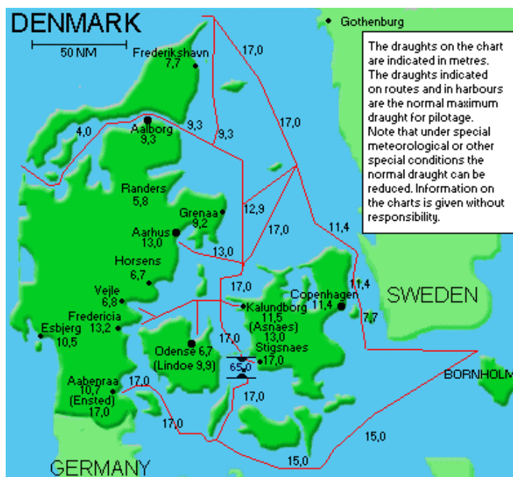
Rys. 1. Dopuszczalne zanurzenie statków na obszarze Bałtyku Zachodniego [9] Fig. 1. Ship's maximum draft in the Western Baltic Sea area
