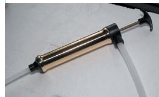
PODZAS WYMIANY OLEJU W SILNIKU NIEZBĘDNY JEST NAM TAKI WŁAŚNIE PRZYZRĄD, ZWANY POTOCZNIE STRZYKAWKĄ
