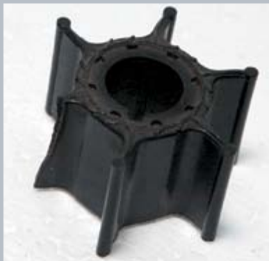
Zużyta pompa obiegu zewnętrznego wody
