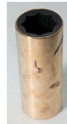
ZEWNĘTRZNA TULEJA PODPOROWA WAŁU ŚRUBOWEGO
