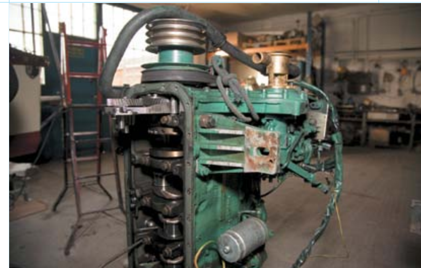
UKŁAD KORBOWODOWO-PANEWKOWY SILNIKA DIESLA ZE ZDJĘTĄ MISKĄ OLEJOWĄ
