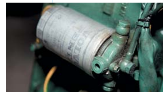
FILTR PALIWOWY DOKŁADNEGO OCZYSZCZANIA. ZALECANA CZĘSTOTLIWOŚĆ WYMIANY CO OKOŁO 100 MOTOGODZIN
