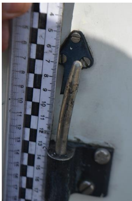
Zdjęcie 4. Dolny zawias i blokada wypadnięcia steru (na prawym kadłubie)
