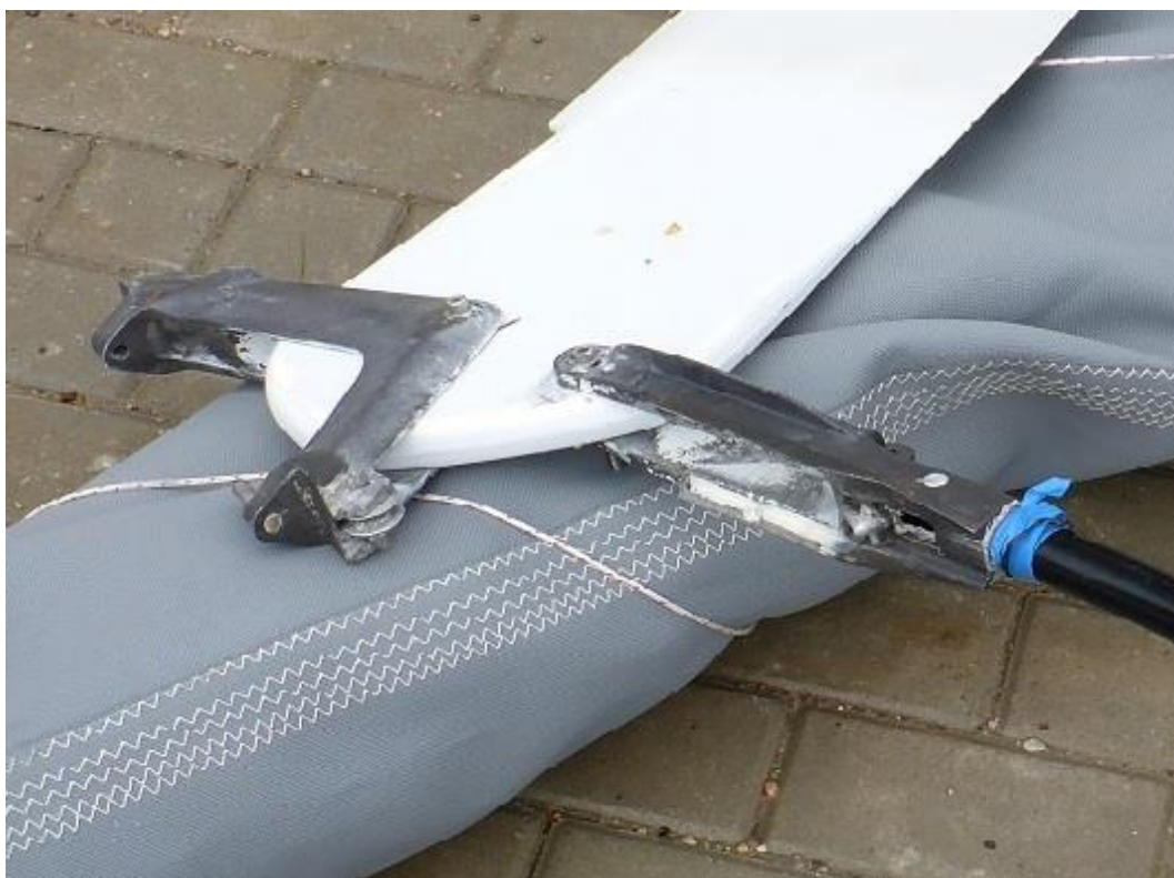
Zdjęcie 2. Jarzmo steru z rolką i zaczepem blokującym
